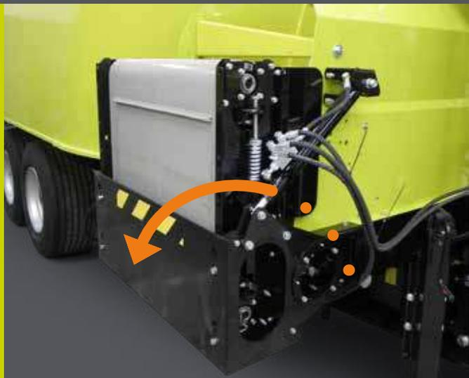
Per ogni porta con tappeto bilaterale che permette lo scarico a sinistra o a destra, ovviamente mai in contemporanea, è possibile poi montare una prolunga di scarico ad azionamento idraulico.
