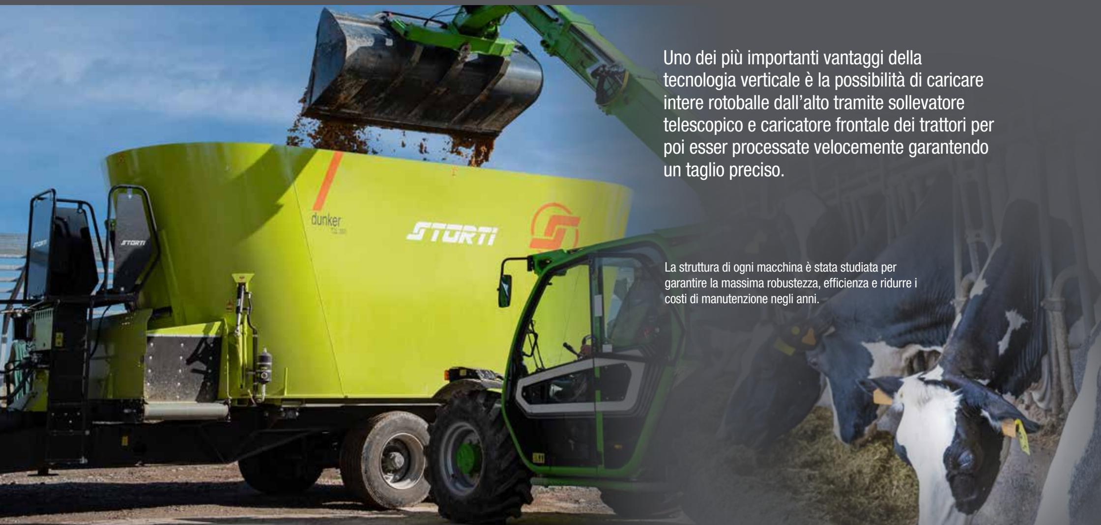
Uno dei più importanti vantaggi della tecnologia verticale è la possibilità di caricare intere rotoballe dall'alto tramite sollevatore telescopico e caricatore frontale dei trattori per poi essere processate velocemente garantendo un taglio preciso.
